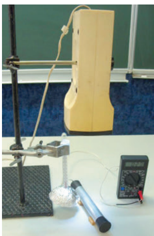
Рис. 3. Модельная установка для определения влияния солнечного излучения на температуру топлива в цистерне и кривые изменения температуры внутри модели цистерны с топливом и снаружи после 10-мин ИК-облучения
