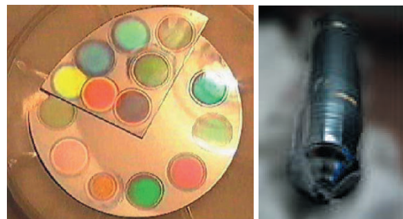
Внешний вид кремния: слева – образцы из нанокристаллов различного размера [3], справа – монокристаллический слиток кремния
