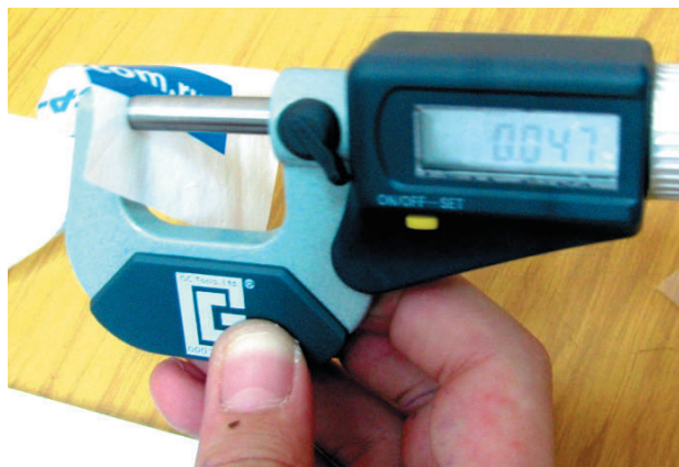
▲ Измерение толщины плёнки электронным микрометром Экспериментальные зависимости ▼
