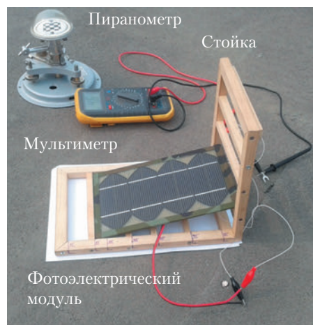
Рис. 2. Оборудование для измерения мощности суммарного потока солнечной радиации
