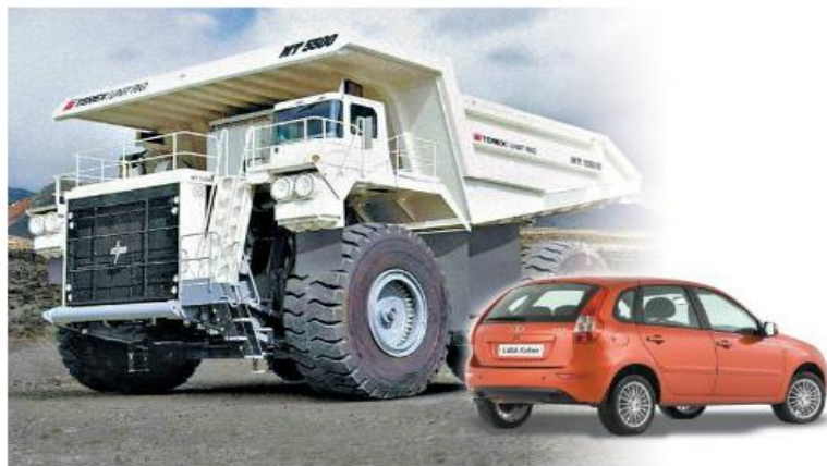
Рис. 91. Увеличение площади опоры для уменьшения давления на поверхность
