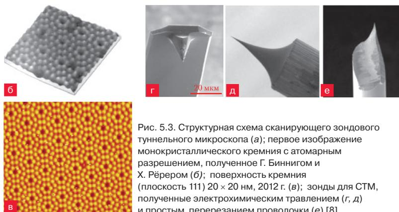
Рис. 5.3. Структурная схема сканирующего зондового туннельного микроскопа (а); первое изображение монокристаллического кремния с атомарным разрешением, полученное Г. Биннигом и Х. Рёером (б); поверхность кремния (плоскость 111)  $20 \times 20$  нм, 2012 г. (в); зонды для СТМ, полученные электрохимическим травлением (г, д) и простым перерезанием проволоки (е) [8]
