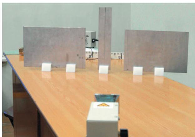
Рис. 8. Установка для демонстрации дифракции на двух щелях
