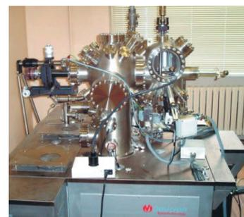
Высоковакуумный сканирующий зондовый туннельный микроскоп
