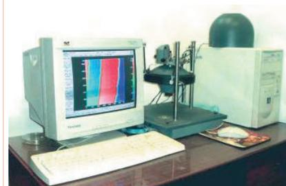
Сканирующий зондовый атомно-силовой микроскоп для лабораторного практикума
