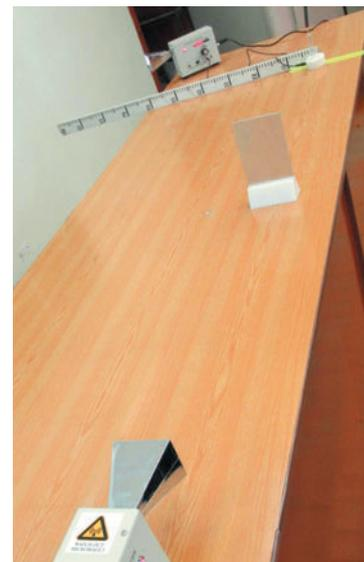
Рис. 7. Установка для демонстрации дифракции электромагнитных волн
