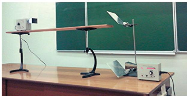
Рис. 3. Модель электромагнитного перископа
