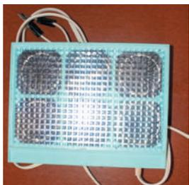
**Ход работы.** Подключите фоторезистор к гальванометру; обратите внимание на положение стрелки; направьте свет от окна на фоторезистор и заметьте новое положение стрелки.
