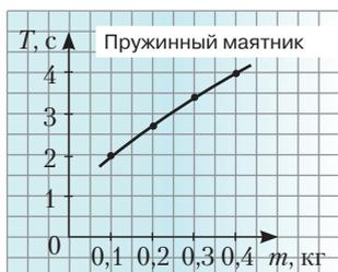
Выявленная **проблема**: зависит ли и как зависит период математического и пружинного маятников от массы груза. Для её решения мы использовали: нить длиной 1 м, пружину заданной жёсткости, набор грузов массой по 100 г, секундомер, калькулятор. **Метод** решения поставленной проблемы – исследовательский. В результате мы увидели (*ученик показывает последнюю колонку в табл. 1*), что число не меняется, а на графике все точки лежат на прямой, параллельной горизонтальной оси.
