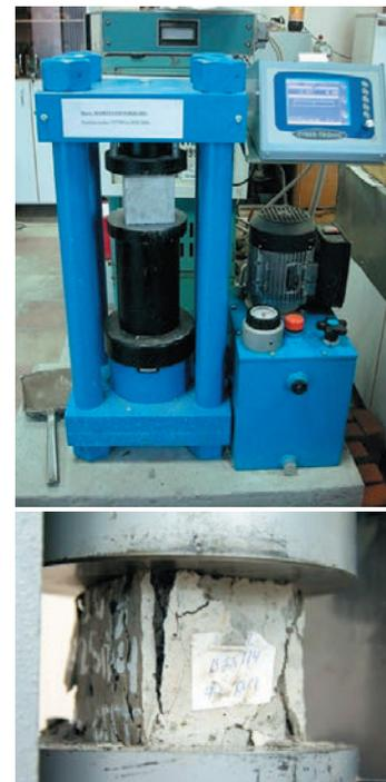
Испытание бетона на прочность
